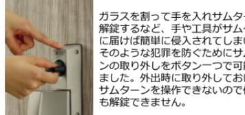
ガラスを割って手を入れサムターンを解錠するなど、手や工具がサムターンに届けば簡単に侵入されてしまいます。そのような犯罪を防ぐためにサムターンの取り外しをボタン一つで可能にしました。外出時に取り外しておけば、サムターンを操作できないので侵入犯も解錠できません。
